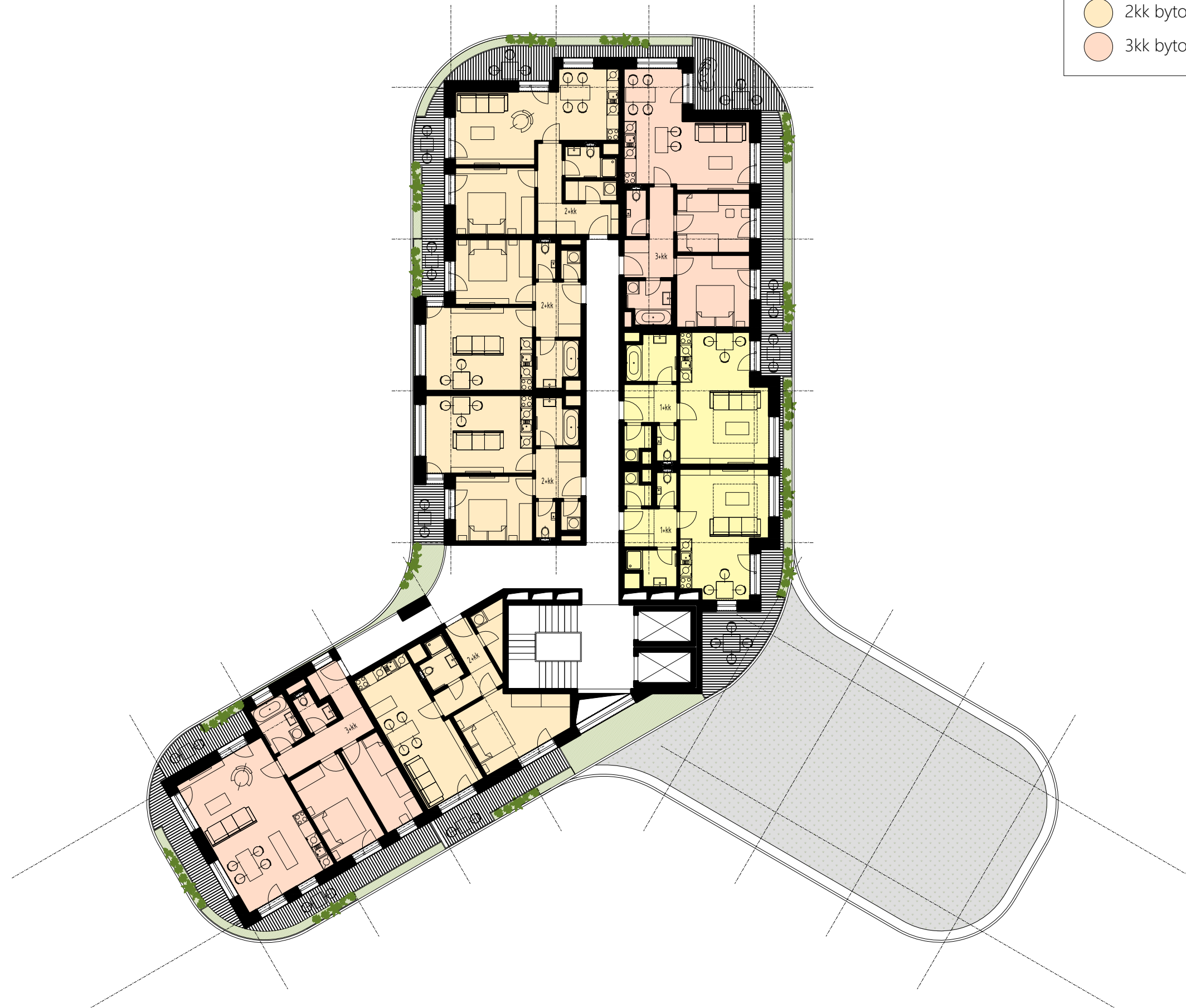
Půdorys typického podlaží bytového domu 1:200
